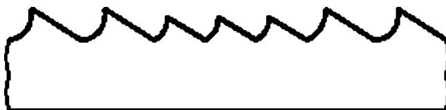
Рисунок 10 — Форма с переменным шагом зубьев
